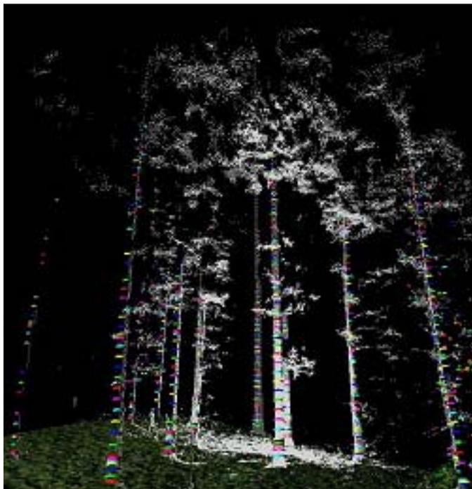
Abbildung 28: VRML und Erstellung der Durchmesserscheiben in verschiedenen Höhen
