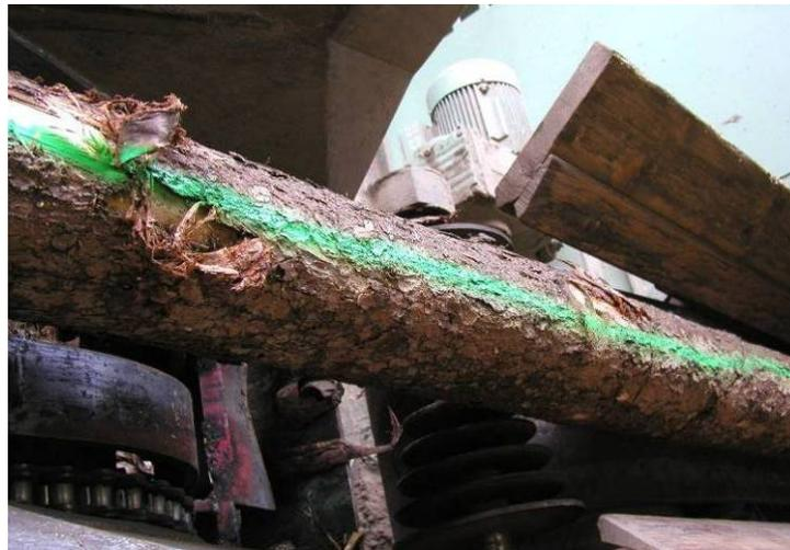
Abbildung 6: Markierung der Messebenen mit Sprühfarbe beim Durchlauf
