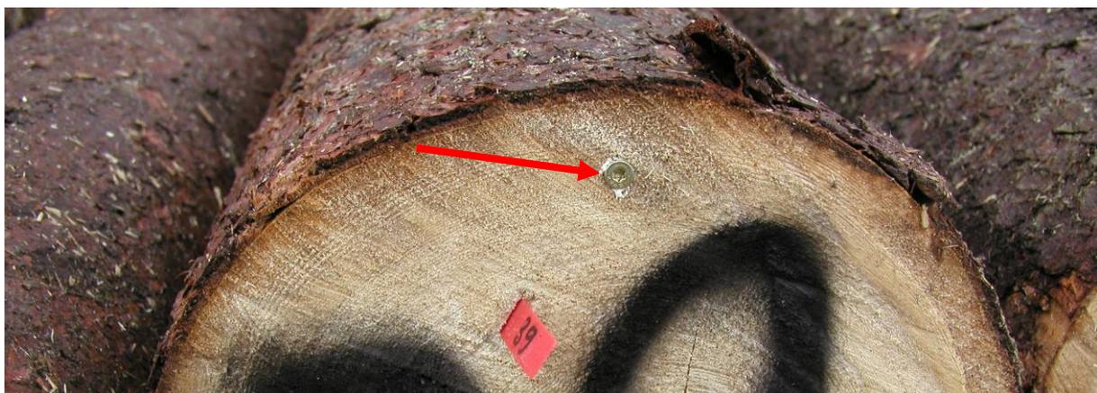
Abbildung 7: Markierung durch eine Schraube
