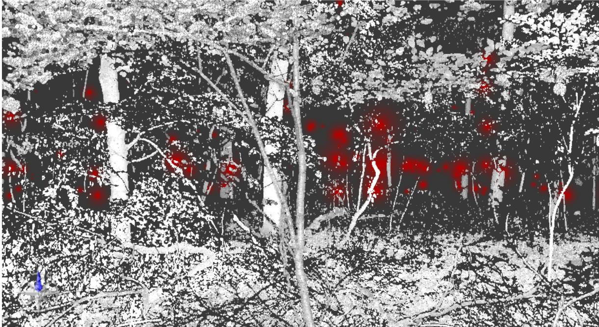
Abbildung 24: Simultane Visualisierung der ALS (rot) und der TLS (grau) Daten im Verarbeitungsprogramm. Die Grauwerte bei der Visualisierung der TLS Daten entsprechen deren Intensitätswerten. Da bei den hier gezeigten ALS Daten keine Intensitätswerte gegeben waren, haben diese alle denselben Rot-Wert. Falls hier ebenfalls Intensitätsdaten vorliegen, können auch diese visualisiert werden.
